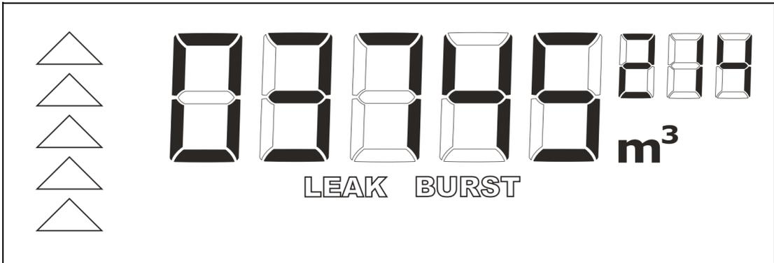
MULTICAL® 21 ist mit einem großen, leicht lesbaren, speziell entwickelten Display versehen. Die fünf großen Ziffern zeigen die Anzahl von Kubikmetern an. Die drei kleinen Ziffern sind Dezimalen. Die Durchflusspfeile links im Display zeigen, dass Wasser durch den Zähler läuft. Wenn es keinen Durchfluss gibt, sind alle Pfeile ausgeschaltet.
